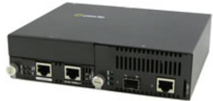
Perle **SMI-10GT Managed Medienkonverter** verbinden 10 Gigabit Ethernet-Verbindungen auf transparente Weise über Multimode oder Single Mode LWL in **Umgebungen, in denen Netzwerksicherheit kritisch ist**. SMI-10GRT unterstützt außerdem die 10/100/1000/2500/10000-Rate-Conversion. Jeder 10GbE Medienkonverter wird mit einem RJ45 10GBase-T Port und einem leeren Slot für ein SFP+ Modul geliefert.
